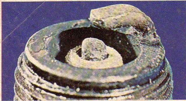
Bild 7. Kraftig elektrodavbränning. Orsak:Naturlig förslitning, tändstiften har gått för länge. Byt stift.
